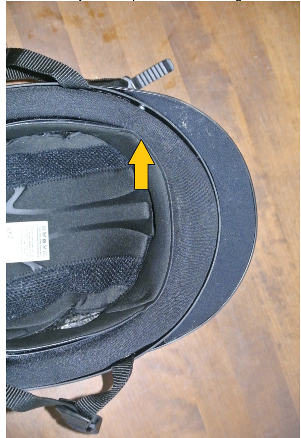
Kuva: kypärä altapäin. Uusissa kypäröissä on tosi paksu tuo vaimentava materiaali. Nuoli näyttää ohimon kohtaa jossa pehmuste meni kasaan ja osin hieman irtosi ulkokuoresta. Iskun voimakkuutta kuvaa se, että sain kuhmun päähäni kohtaan joka lyttää kypärän pehmukkeeseen. Pakko hankkia uusi. Siis kypärä.
